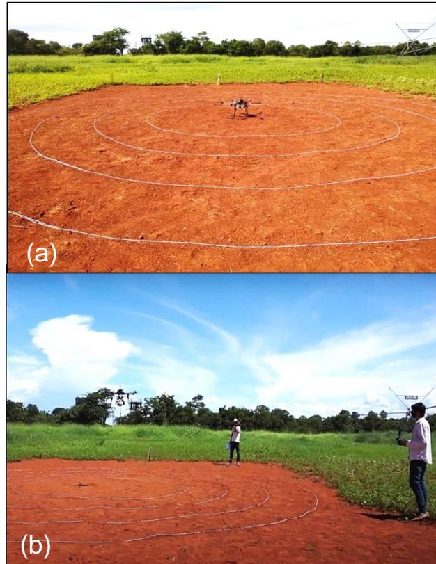
Figura 8 - Procedimento de voo. (a) posicionamento inicial da aeronave ao centro da pista. (b) a aeronave pairando acima do solo durante o alinhamento com apoio de um observador auxiliar posicionado ortogonalmente à linha de visada do piloto. Fonte: autor
