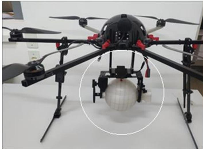
Figura 1- RPA Hexacóptero modelo X800 com sistema de dispersão embarcado. Fonte: autor.
