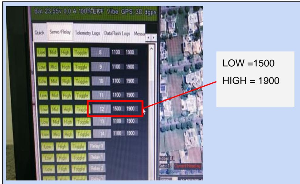
Figura 4 - Interface do Software Mission Planner durante o processo de configuração dos parâmetros de velocidade do servo motor. Fonte: autor.
