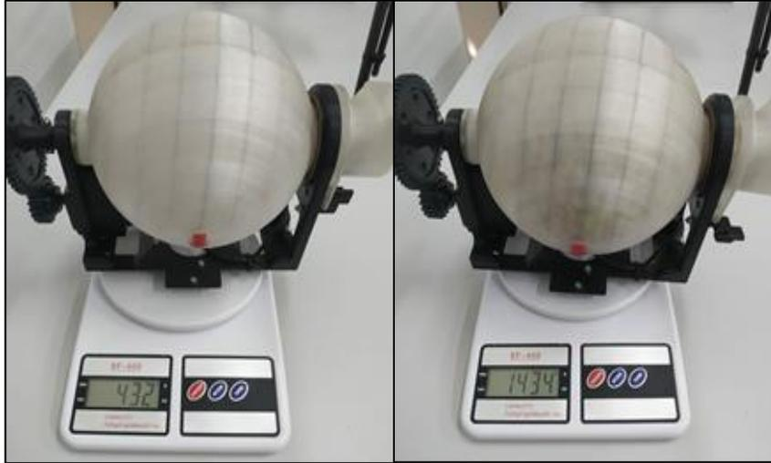
Figura 3 Procedimento de obtenção da capacidade máxima do dispensador com sementes de feijão. (a) peso do equipamento vazio e (b) peso do equipamento totalmente preenchido. Fonte: autor.
