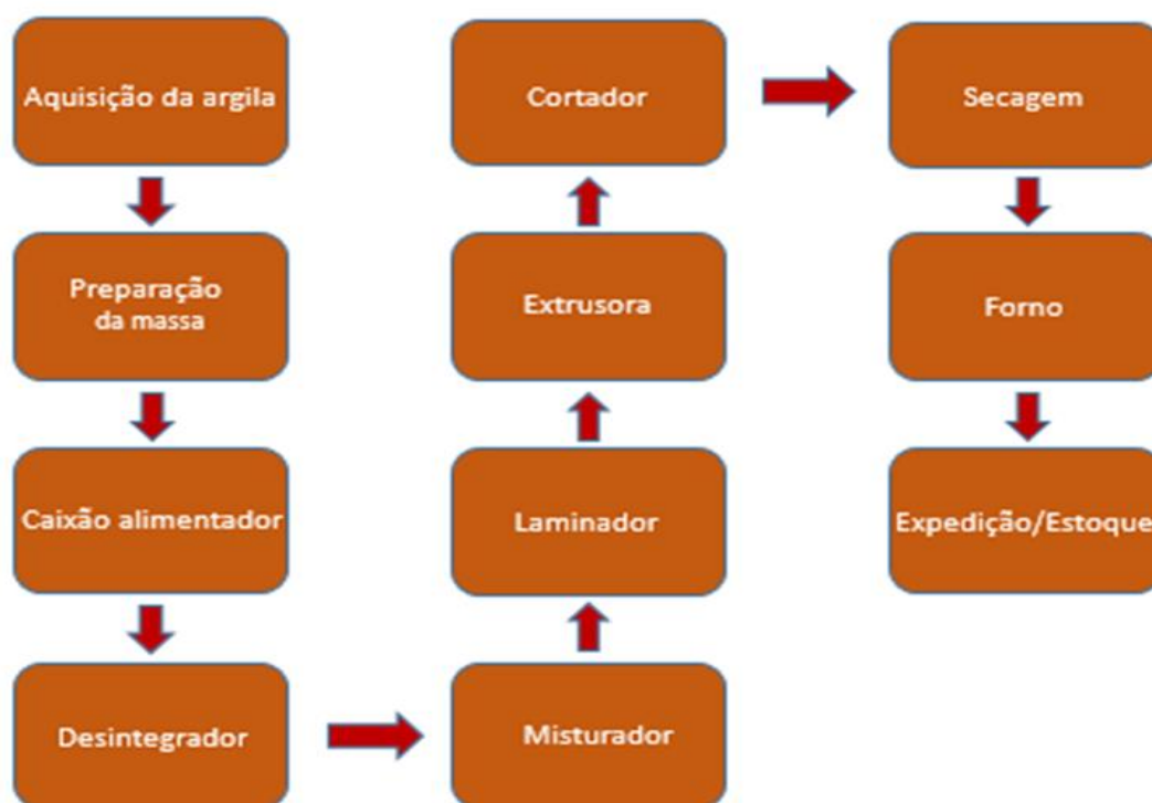
Figura 1 - Esquematização do processo de produção Fonte: Adaptado de (Vieira; Carvalho, 2016)
