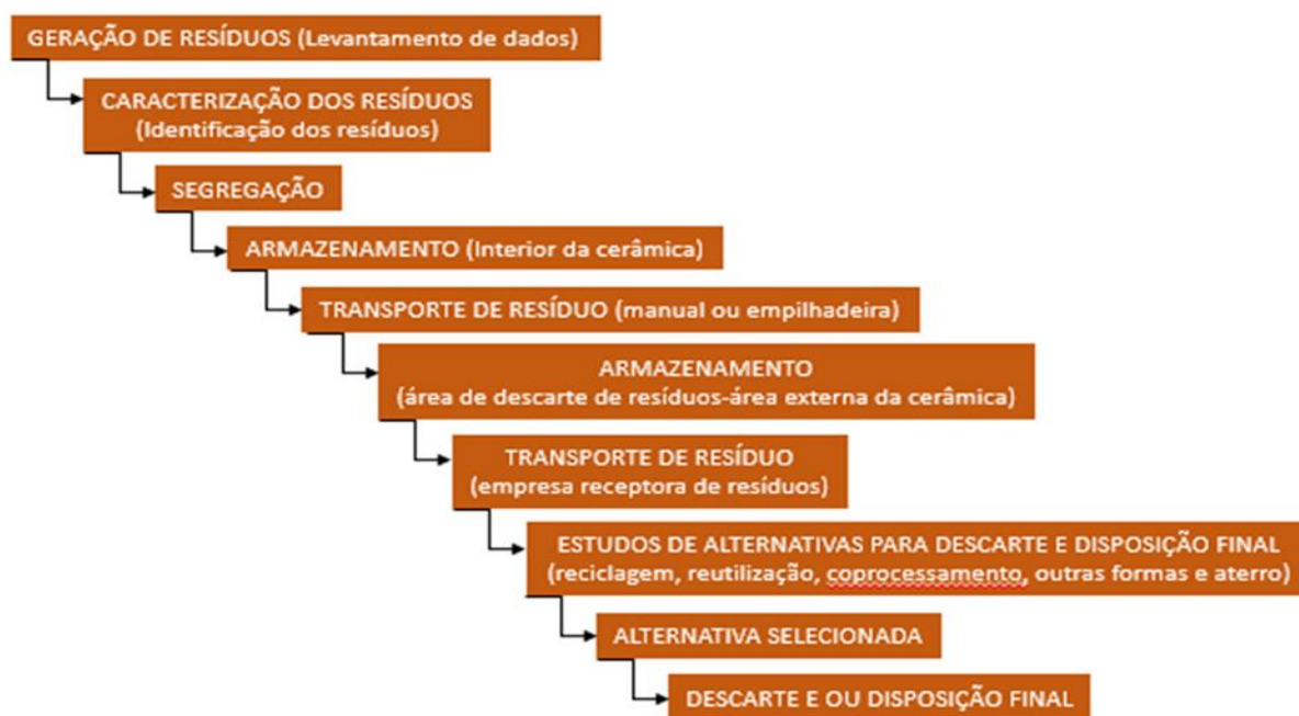
Figura 3 - Fluxograma das etapas do gerenciamento dos resíduos sólidos desenvolvida na cerâmica Fonte: Adaptado de Biff (2016).
