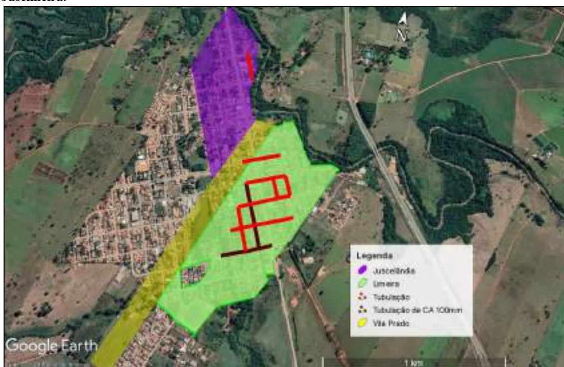
Figura 5.2.1.10 - Espacialização da rede de distribuição de água construída com CA na cidade de Juscimeira.
