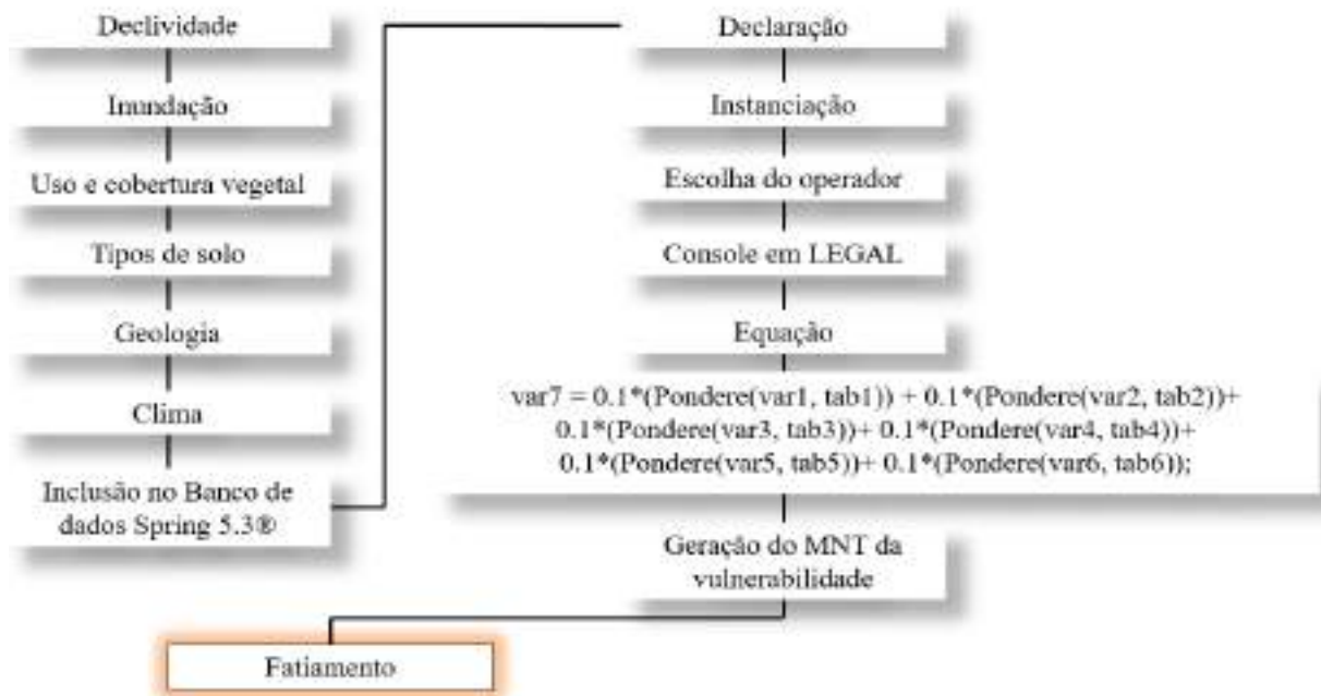
Figura 10 – Organograma com as etapas metodológicas para a construção do mapa de Vulnerabilidade Ambiental da bacia do rio Mutum. Da autora (2016).
