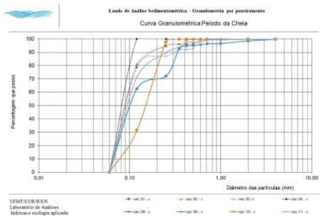
Figura 34 – Curva granulométrica dos sedimentos analisados na cheia, sendo que as seções que não aparecem integralizadas no gráfico não foram inseridas porque a granulometria foi 100% areia muito fina-silte-argila.
