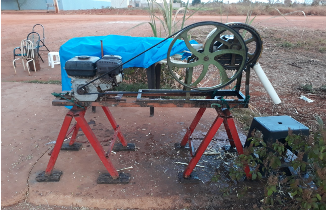
Figura 20. Máquina de Moer Cana – Periferia da Cidade – Distrito Industrial Org. TEODORO. C. A (2018).
