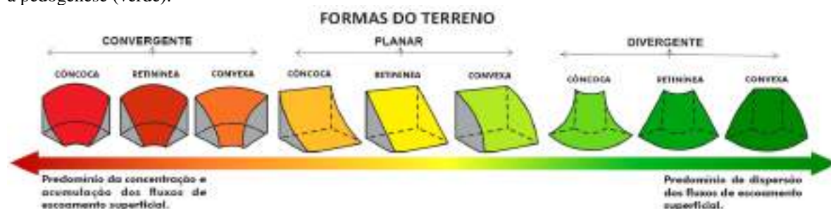
Figura 2.2 – Blocos diagramas das formas do terreno com o gradiente de atuação dos fluxos no escoamento superficial, sendo a porção esquerda (vermelho) concentradora de fluxos do escoamento superficial, com maior tendência a alterações da morfogênese, e a porção direita, dispersora do escoamento superficial, mais favorável à pedogênese (verde).
