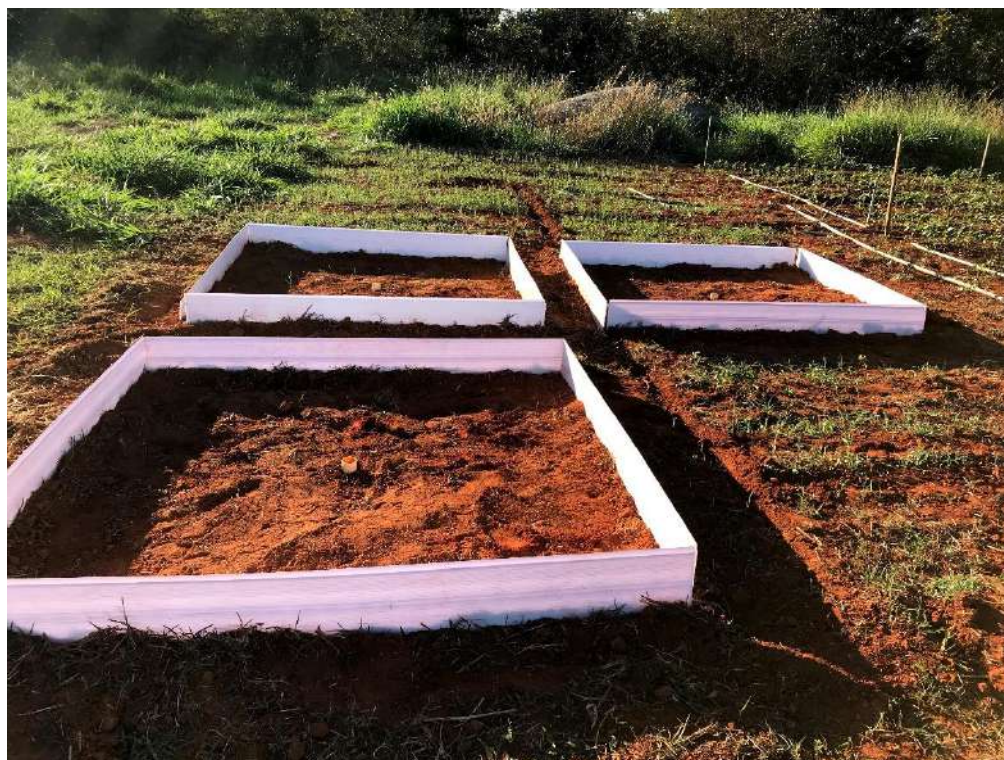
Figura 3 - Montagem das parcelas do experimento com as placas de PVC.
