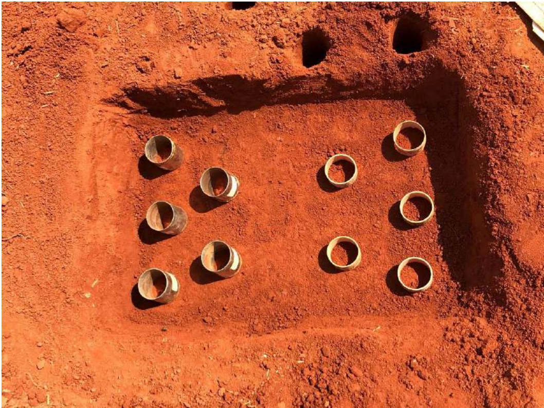
Figura 6 - Coleta do solo com anéis de 100 (à esquerda) e 50 (à direita) cm^3 .
