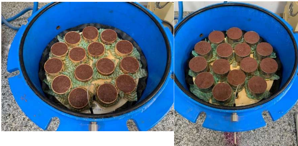
Figura 7- Amostras indeformadas de 50 cm 3 (esquerda) e 100 cm 3 (direita) na câmara de pressão de Richards.
