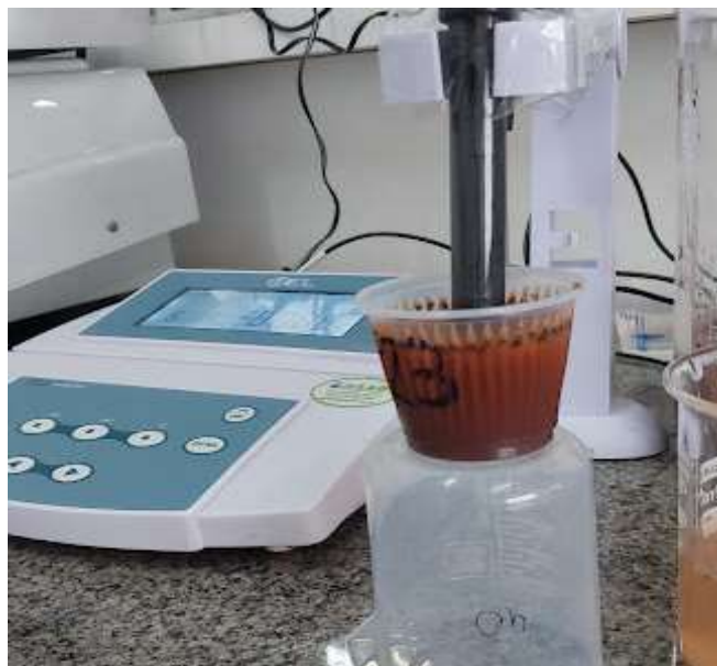
Figura 4. Leitura de pH das unidades experimentais com o uso de pHmetro digital, com solução de cloreto de cálcio ( \text{CaCl}_2 ) como reagente, no Laboratório de Água e Solo (NuPec-UFR).
