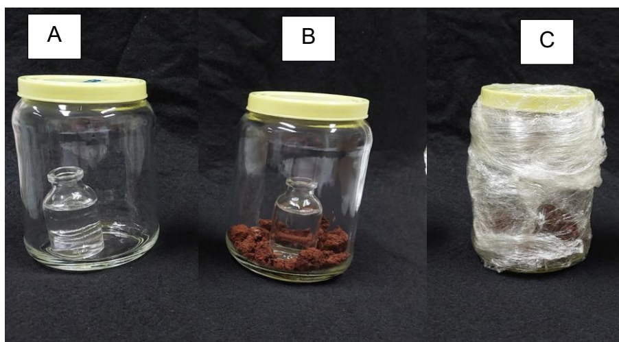
Figura 5. Amostras preparadas para respiração basal do solo. (A) Branco da análise que contém apenas solução de hidróxido de sódio e cloreto de bário no vidro pequeno. (B) Amostra com solo, mais o vidro com a solução de hidróxido de sódio e cloreto de bário. (C) Amostra completa.
