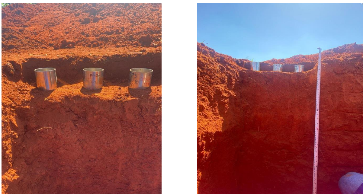
Figura 7. Trincheira e anéis volumétricos utilizados para coleta de amostras para determinação da condutividade hidráulica saturada do solo da área experimental da UFR (Latosolo Vermelho), em Rondonópolis cultivado com algodão, em 2023 e 2024. Fonte: Acervo do autor
