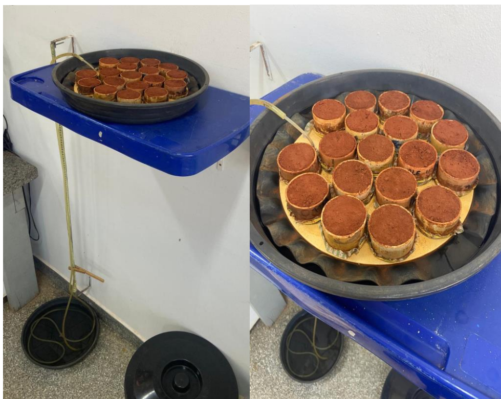
Figura 10. Mesa de tensão utilizada para determinação do teor de umidade em amostras submetidas às sucções de 1; 6 e 10 kPa, do solo da área experimental da UFR (Latosolo Vermelho), em Rondonópolis cultivado com algodão, em 2023 e 2024. Fonte: Acervo do autor
