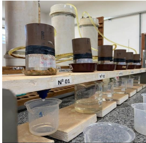
Figura 8. Permeômetro de carga constante para determinação condutividade hidráulica saturada do solo da área experimental da UFR (Latossolo Vermelho), em Rondonópolis cultivado com algodão, em 2023 e 2024. Fonte: Acervo do autor
