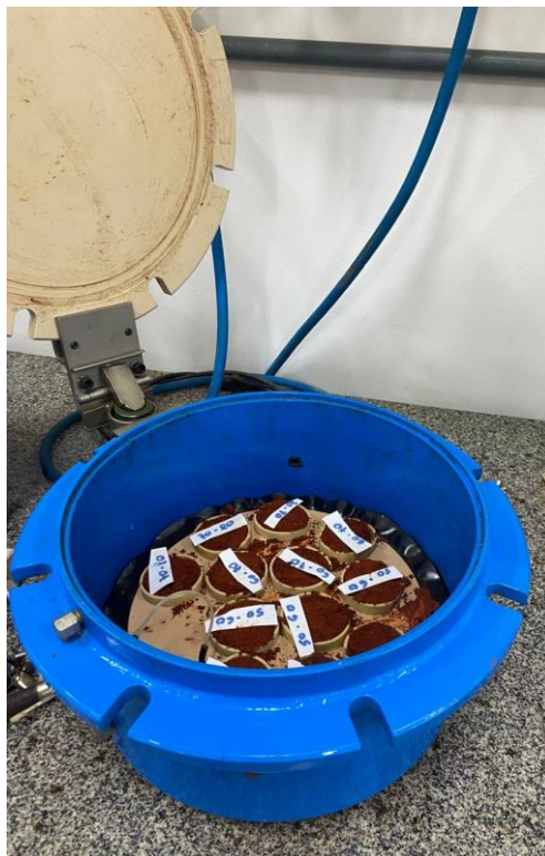
Figura 11. Aparelho extrator de Richard utilizado para determinar o ponto de murcha permanente do solo da área experimental da UFR (Latosolo Vermelho), em Rondonópolis cultivado com algodão, em 2023 e 2024. Fonte: Acervo do autor
