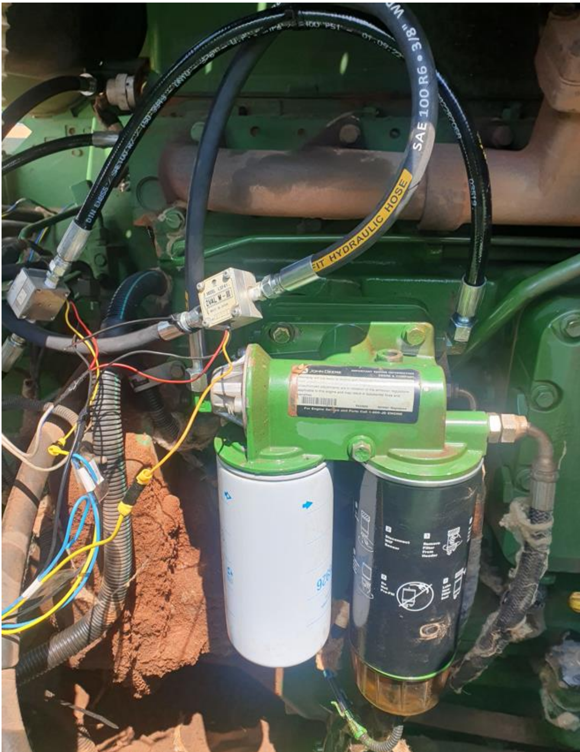
Figura 10 – Fluxômetros de entrada e retorno devidamente conectados às linhas de combustível e a fonte geradora de tensão (alternador) Fonte: O autor.
