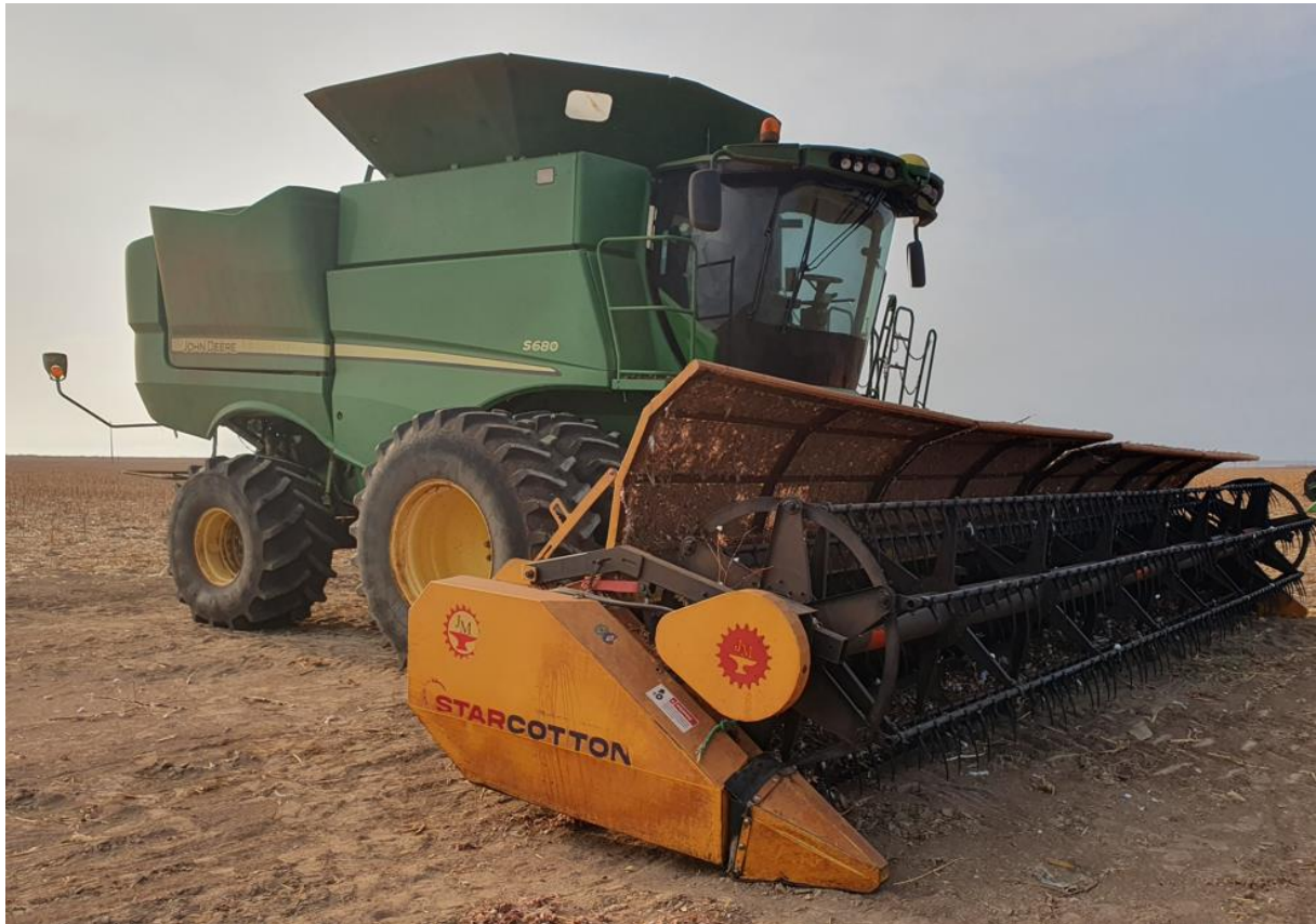
Figura 18 – Plataforma Específica desenvolvida para a roçagem do algodão, acoplada à colhedora utilizada.
