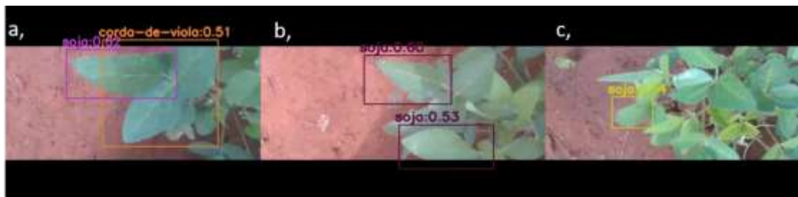
Figura 20. Imagens das câmeras durante repetições em campo (a) detecção de folha de soja de maneira incorreta e correta, (b) e (c) folhas de soja detectadas e não detectadas pelo algoritmo YOLOv3 tiny.
