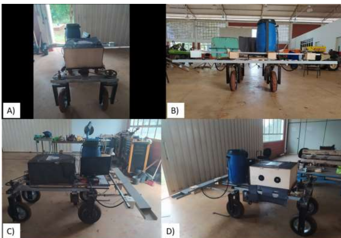
Figura 6. A) visão frontal, B) visão traseira, C) visão lateral direita, D) visão lateral esquerda do protótipo de pulverizador seletivo desenvolvido em conjunto com o grupo Smart Agriculture.
