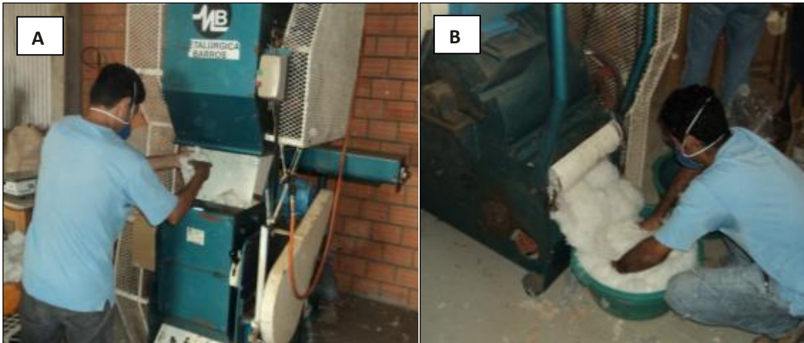
Figura 11. (A) Operador alimentando com algodão em caroço o descaroçador de 20 serras; (B) Saída do algodão processado sem a presença de caroço. Foto: Renato Tillmann Bassini, 2014.
