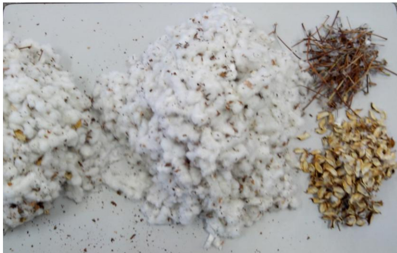
Figura 10. Caule e casquinha separados manualmente da pluma para quantificar a quantidade de impureza presente na fibra.
