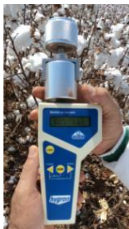
Figura 7. Equipamento de medição portátil da marca Hygron utilizado para monitorar a umidade durante a colheita.
