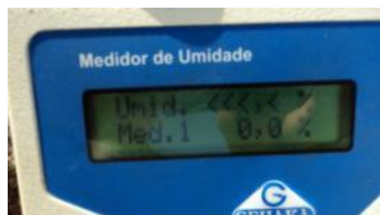
Figura 7. Equipamento de medição portátil da marca Hygron utilizado para monitorar a umidade durante a colheita.
